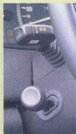
Regulacja położenia kolumny kierownicy (od 1997 r.)
